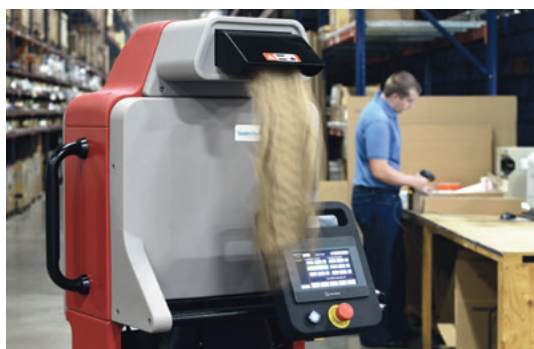
Distribution automatique du prochain coussin de rembourrage
