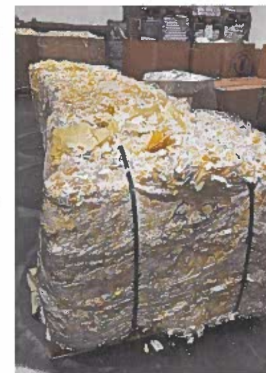
Durch Fischer Papier komprimierte Release-Liner-Ballen vor der Weiterverarbeitung durch Lenzing.
